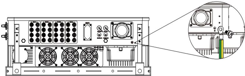
Image 5.11 Installation du conducteur de terre du boîtier
