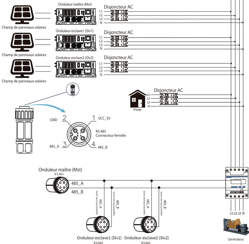
Image 7.31 Schéma de connexion CHINT (table de passage)
