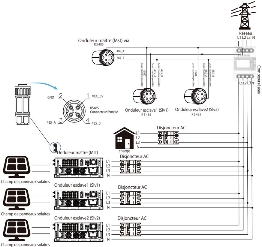
Image 7.21 Schéma de connexion Eastron (table de passage)
