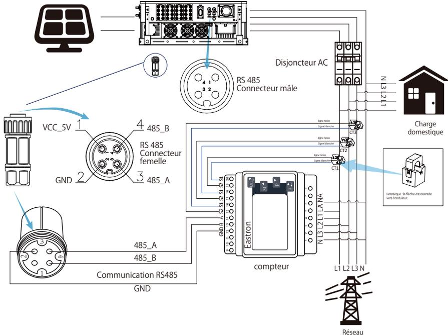
Image 7.6 Schéma de connexion du compteur Eastron
