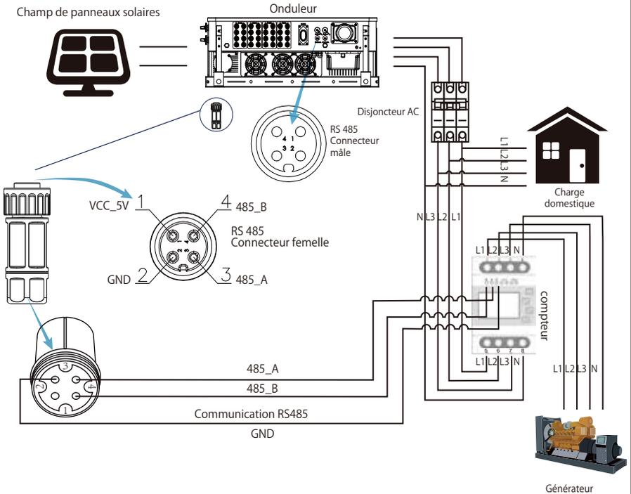
Image 7.4 Schéma de connexion du compteur Eastron
