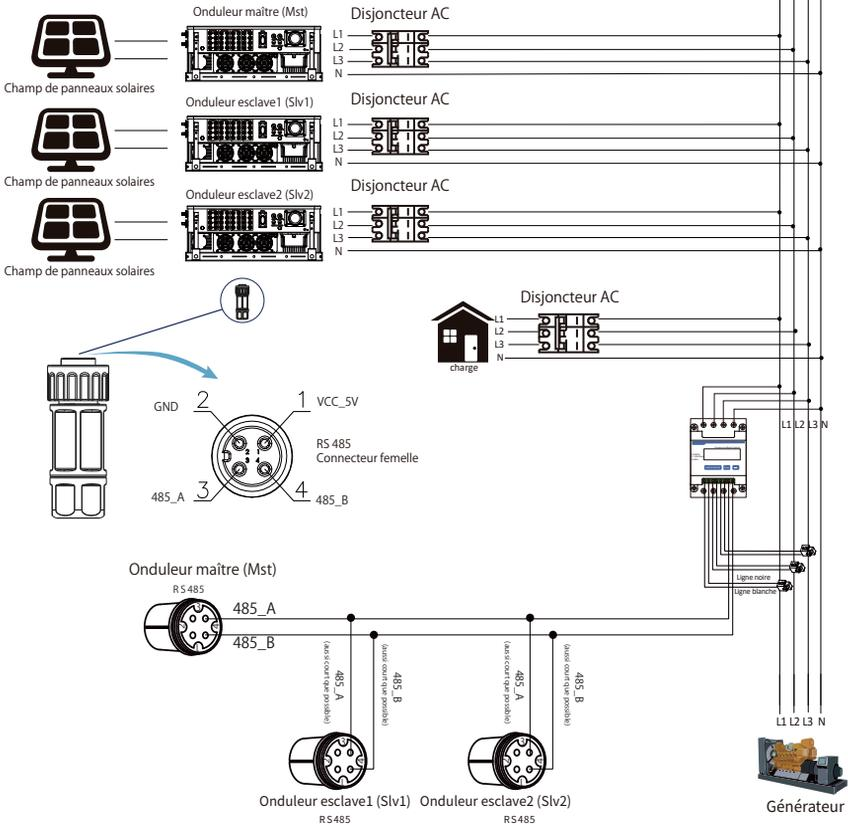
Image 7.35 Schéma de connexion CHINT (table de passage)
