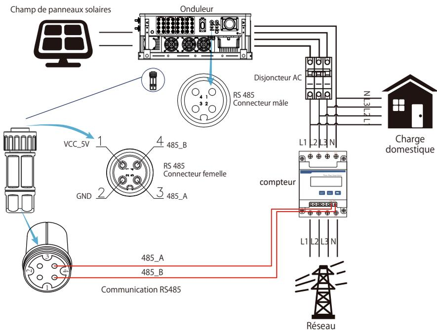
Image 7.10 Schéma de connexion du compteur CHINT
