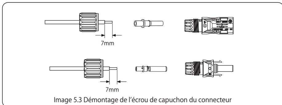
Image 5.3 Démontage de l'écrou de capuchon du connecteur
