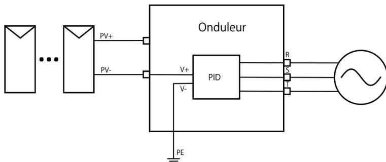
Le module Anti-PID corrige l'effet PID des modules photovoltaïques pendant la nuit. Le module fonctionne en continu lorsqu'il est raccordé au secteur.
