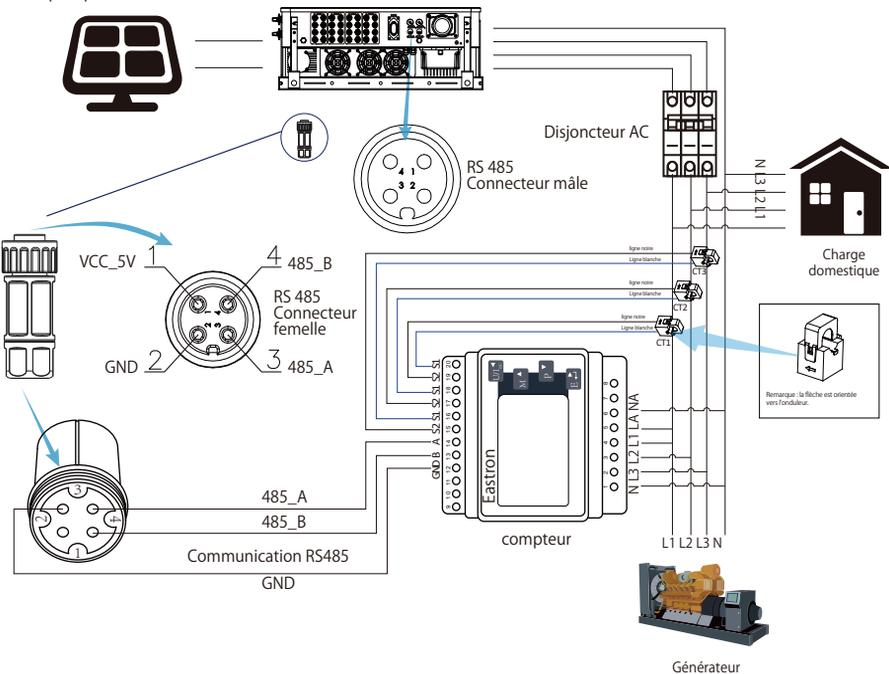
Image 7.8 Schéma de connexion du compteur Eastron
