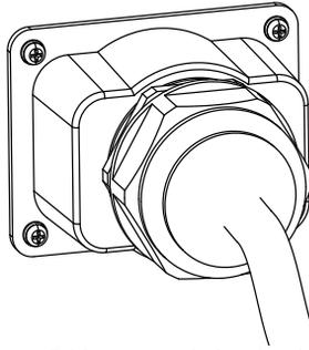
Image 5.11 Serrage du boîtier de raccordement AC
