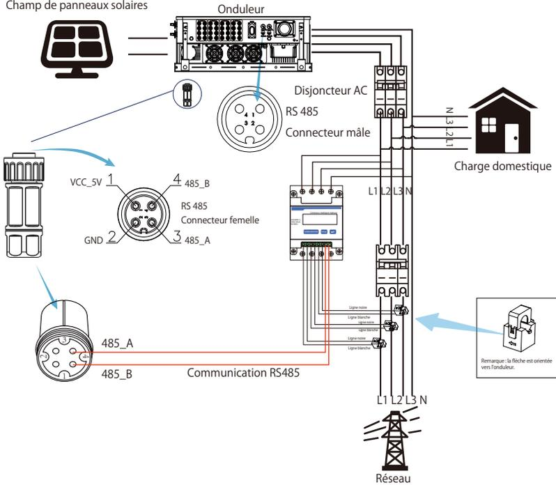
Image 7.14 Schéma de connexion du compteur CHINT
