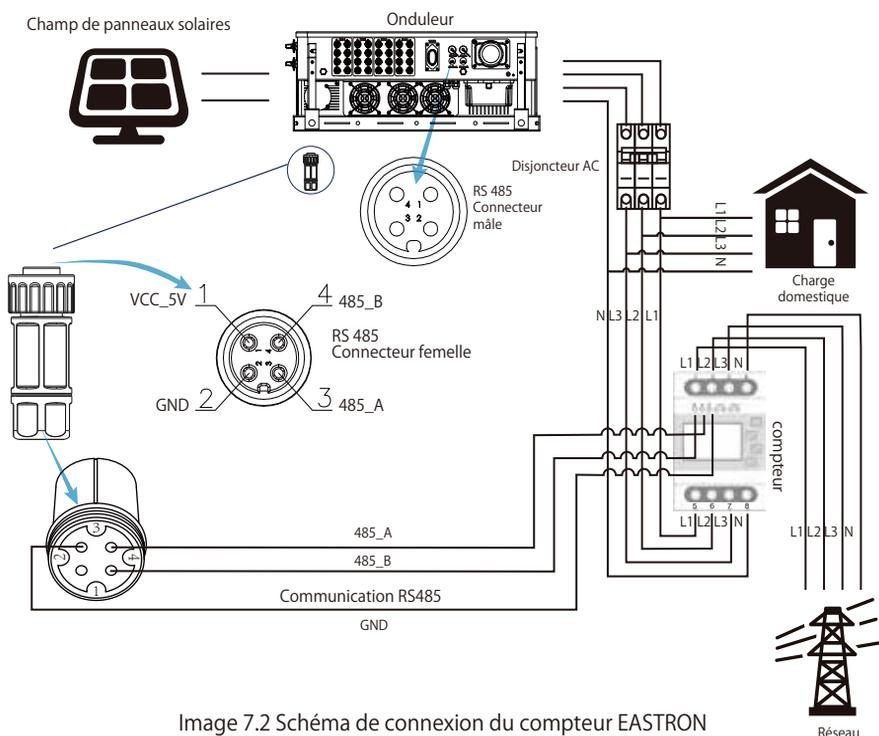
Image 7.2 Schéma de connexion du compteur EASTRON
