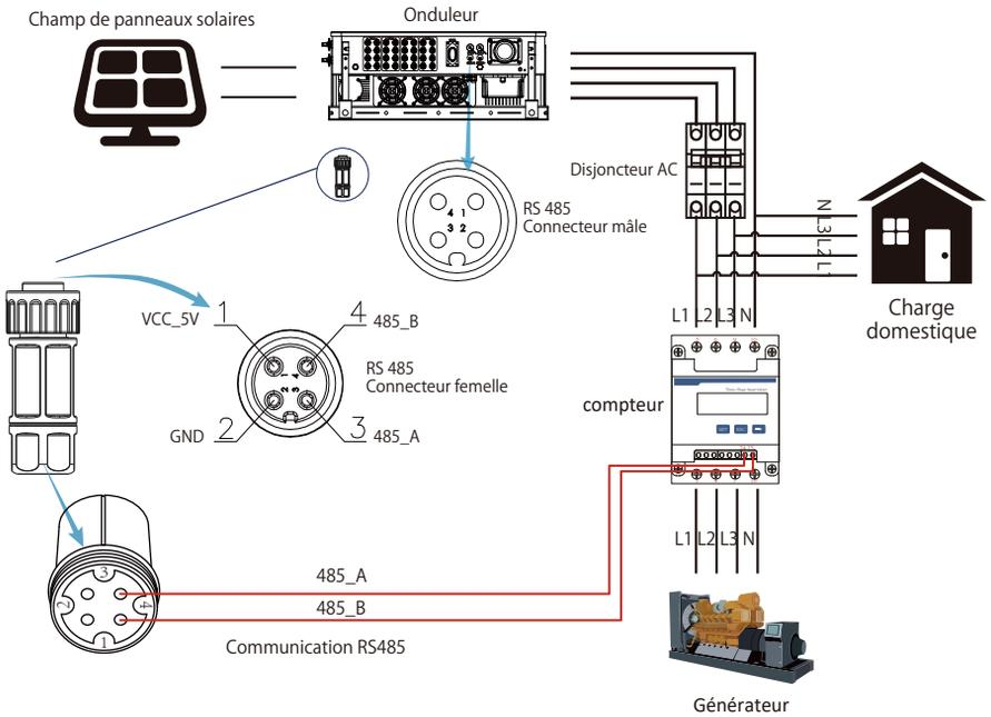
Image 7.12 Schéma de connexion du compteur CHINT
