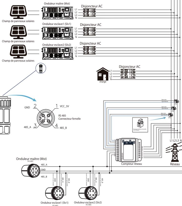
Image 7.25 Schéma de câblage (électricité triphasée)
