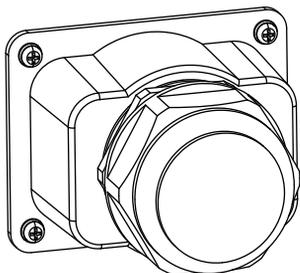
Image 5.7 Boîtier de raccordement AC
