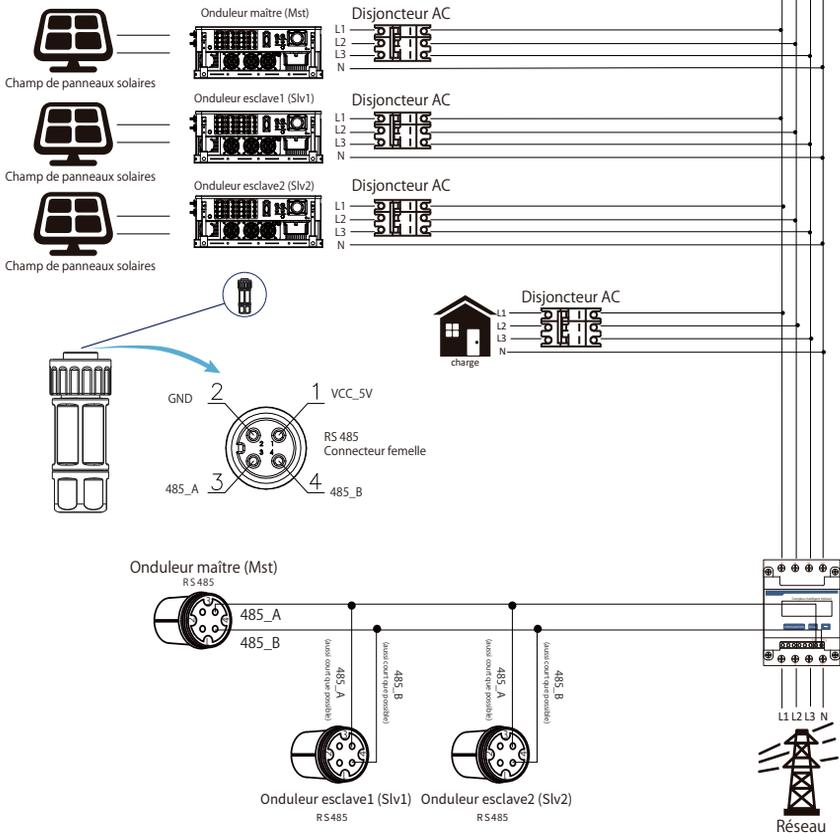
Image 7.29 Schéma de connexion CHINT (table de passage)
