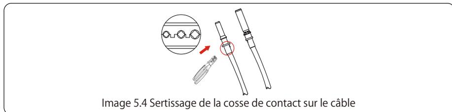
Image 5.4 Sertissage de la cosse de contact sur le câble
