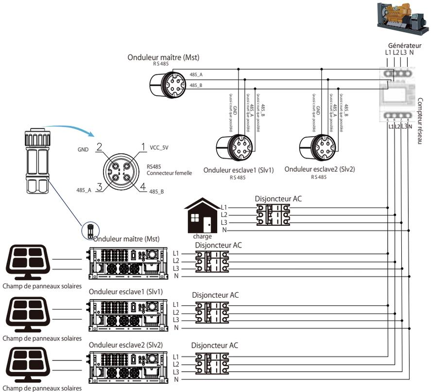
Image 7.23 Schéma de connexion Eastron (table de passage)
