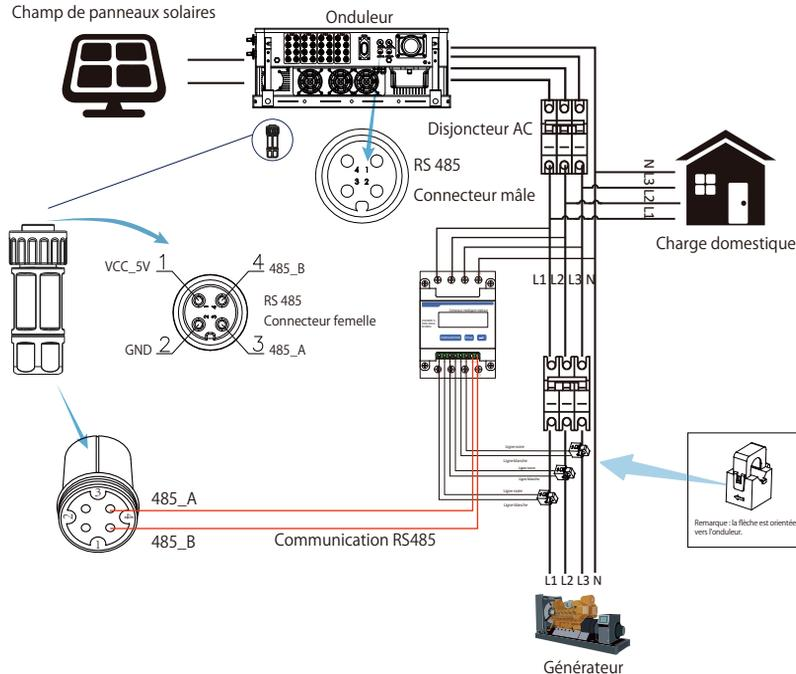
Image 7.16 Schéma de connexion du compteur CHINT
