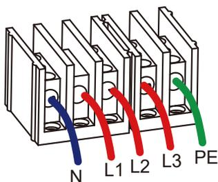
Image 5.9 Connexion des câbles AC aux bornes
