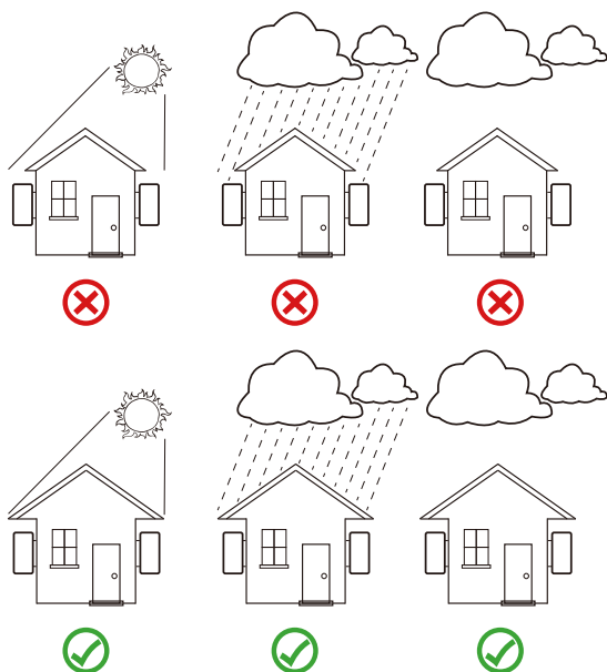
Image 4.1 Emplacement d'installation recommandé
